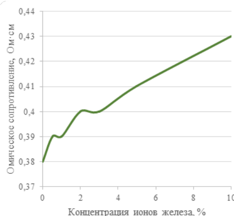
Рис. 9. Зависимость омического сопротивления КР №2 при моделировании дестабилизации ИК
